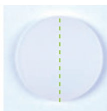
Variolink Esthetic, test d'exposition à la lumière (conforme ISO 4049), Partie gauche exposée à la lumière
